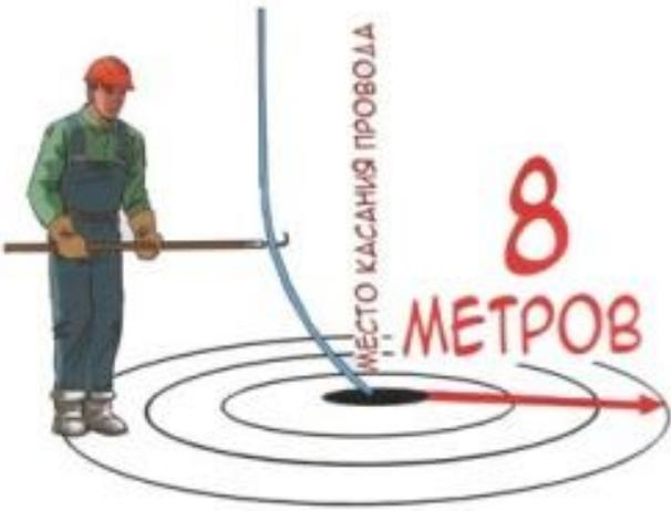
**Действия при случайном попадании в зону шагового напряжения**
